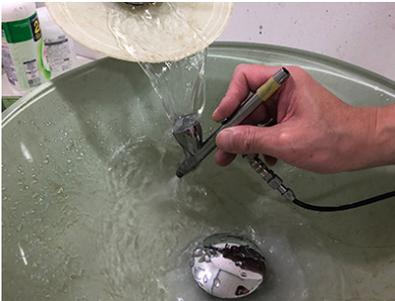
水性塗料を使用した後は、水道水やバケツに水を張って洗浄します。
