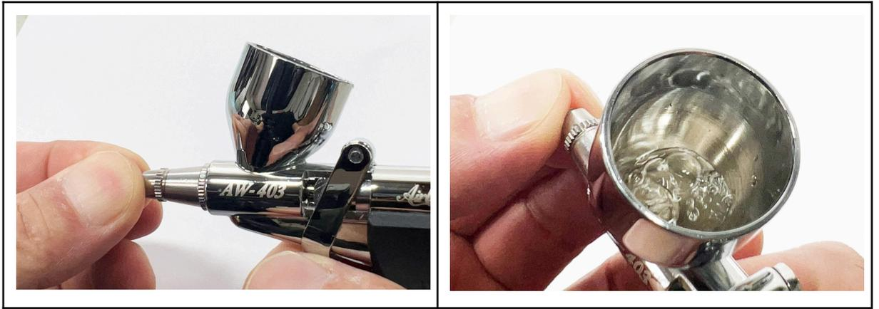
上手く逆流しない場合、ウエスや柔らかい布を使用して先端を摘むと良いでしょう。これにより、より密閉された状態を作り出し、効果的にエアの逆流を促進します。
