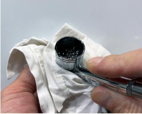
シンナーなどの洗浄液をエアブラシのカップに入れます。吹き付けと逆流を交互に行い、洗浄液が透明になるまで繰り返して内部を洗浄します。
