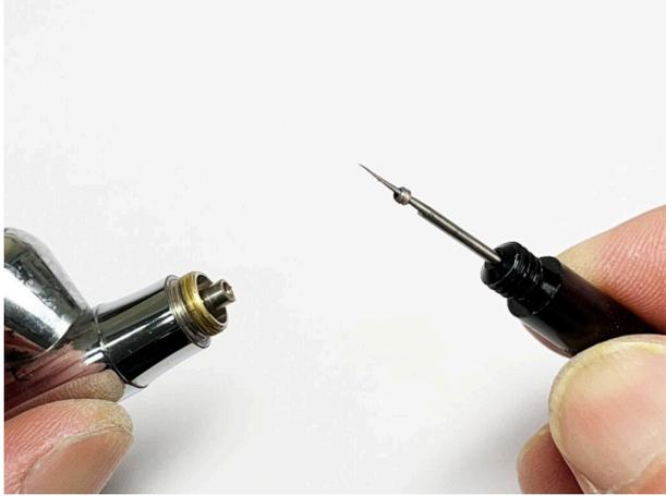
ノズルを強く締めると簡単に折れるので、締め過ぎに注意して下さい。ノズルが折れてしまった場合下記の記事を参照して下さい。
