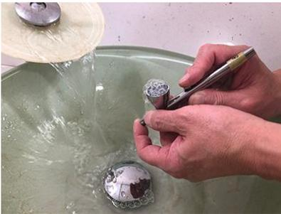
エアブラシから水が透明になるまで、水を逆流させて内部を洗い流します。ただし、逆流だけではノズル内部に空気しか入らないため、吹き付けと逆流を交互に繰り返すことが効果的です。
