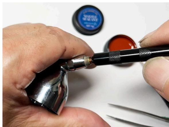
ノズルレンチで取り付けます。締め過ぎると簡単に折れてしまうので、止まった所から少しだけ増し締めする程度に締めます。
