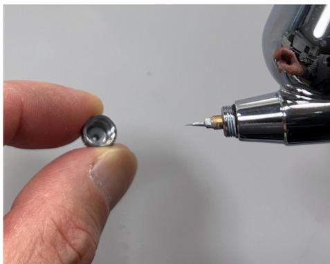
ノズルキャップを外して確認します。画像の様に塗料が付着していたら掃除が必要です。
