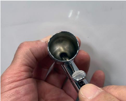
最後にシンナーなどの洗浄液をもう一度エアブラシに入れて逆流させます。この時、洗浄液が透明になっていれば、内部が十分に洗浄されていることを示しています。
