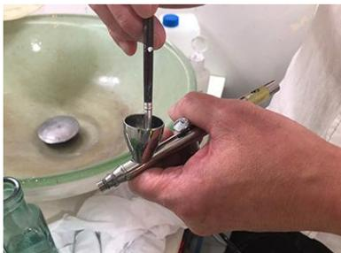
塗料が固まってしまった部分は、洗浄液と硬めの筆（豚毛の平筆がお勧め）を使用して、固まった塗料を溶かしながら洗浄します。この方法で、エアブラシの内部を綺麗に保つことができます。
