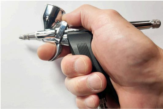
グリップを利き手でしっかりと握り、トリガーに人差し指をかけます。この方法は、トリガーへのアクセスが容易で、精密なコントロールが求められる場面に適しています。
