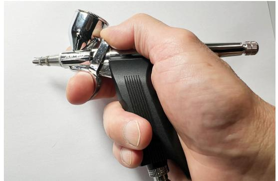
手の大きさによっては、トリガーを中指で操作の方が快適に感じる場合があります。この持ち方は、より力強くトリガーを操作でき、長時間の使用でも疲れにくい利点があります。
