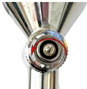
取り外しはレンチを使用し、左側に回して下さい。右側に回した場合簡単に折れてしまうのでご注意下さい。
